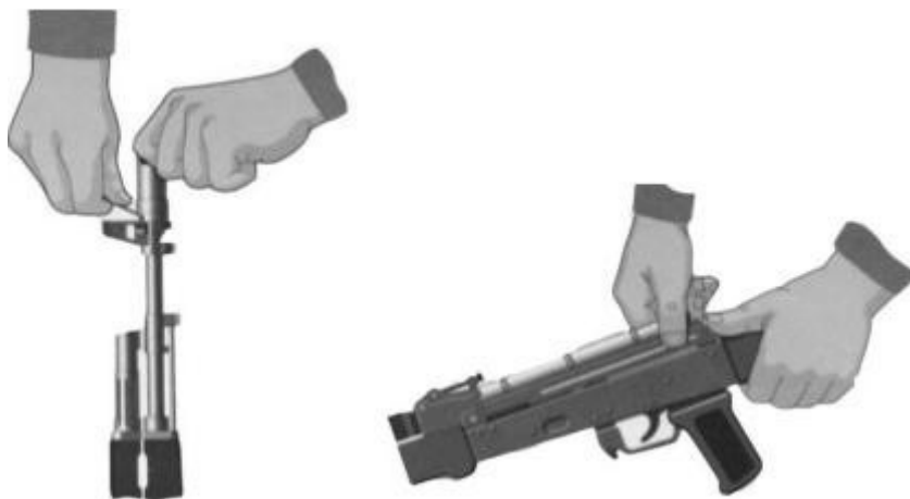
Рис. 7.13. Отделить Рис. 7.14. Отделить крышку шомпол ствольной коробки
