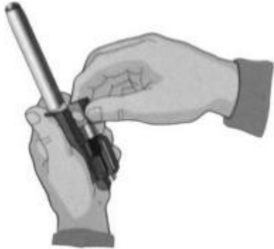
Рис. 7.17. Отделить затвор от затворной рамы
