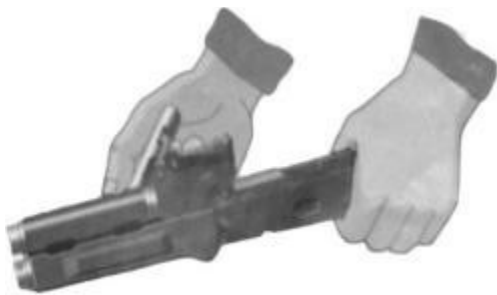
Рис. 7.18. Отделить газовую трубку со ствольной накладкой
