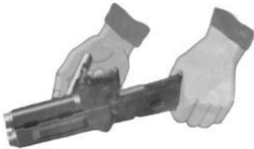
Рис. 7.18. Отделить газовую трубку со ствольной накладкой
