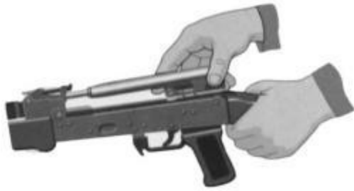
Рис. 7.16. Отделить затворную раму с затвором
