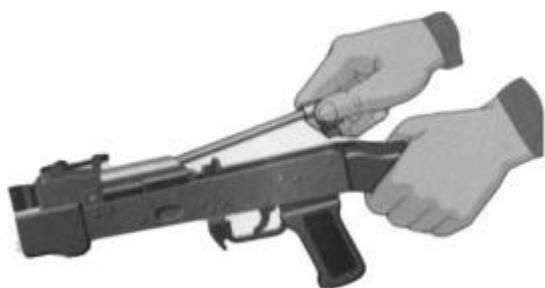
Рис. 7.15. Отделить возвратный механизм
