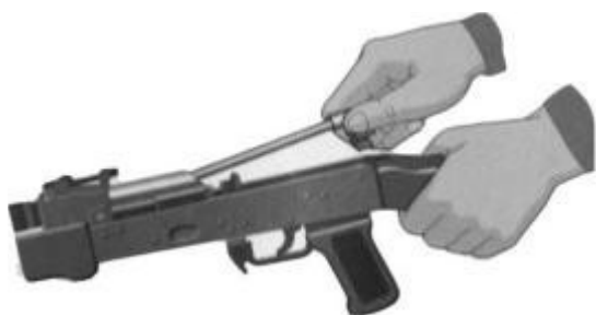
Рис. 7.15. Отделить возвратный механизм
